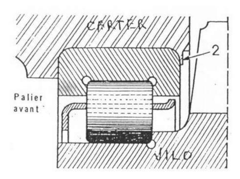
Pour le remontage les opérations seront effectuées en sens inverse : chauffer, introduire le roulement (sans cales!), sertir par quatre matages équidistants et laisser refroidir.
