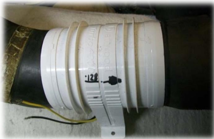
Fabriquer la fixation du ventilateur sur la tôle sous planche avec 2 cornières alu, en prévoyant des lumières de réglage vertical. Cette fixation devra être la plus basse possible pour laisser le passage à la biellette des essuie-glaces. Au montage positionner la biellette à 180° de la position de repos normale et s'assurer qu'il n'y a pas d'interférence. Attention car en l'absence de la planche de bord, la tôle inférieure fléchit, la caler à la bonne hauteur .
