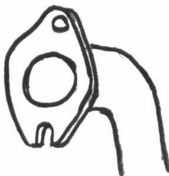
Préparer deux boulons de diamètre 8, longueur 40, tête de 13 mm sur le plat, et les visser par l'arrière sur le "bénitier" à la place des goujons en les faisant juste affleurer le plan de joint.
