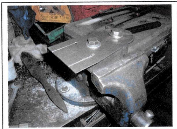
Mise en place du développé a plat sur la forme
